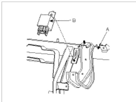
6. 当端子2和端子4分别连接电源和搭铁时,端子1和端子3之间应导通。
